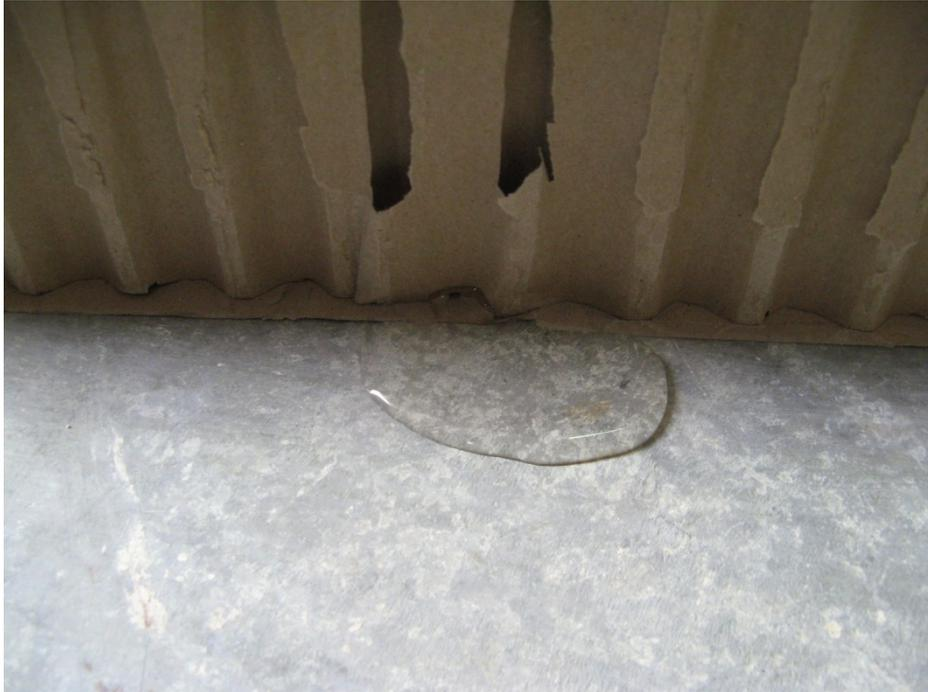
*Photo 8 : Détection visuelle de l'eau sur l'un des côté après son introduction par le tube PVC*
